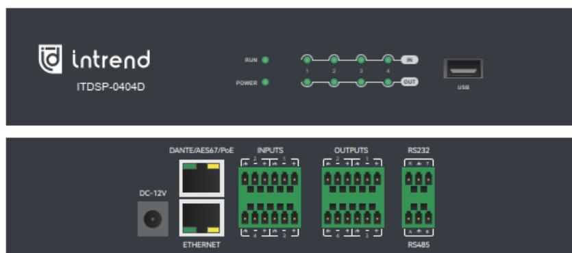
INTREND ITDSP-0404D – это универсальный цифровой сигнальный процессор на основе архитектуры A-DSP с 40-битной плавающей запятой, производительностью до 400 MIPS, 1600 MFLOPS, с фиксированными 4 аналоговыми входами и 4 аналоговыми выходами, каналами Dante 4x4 и встроенным аудио по USB, который может обрабатывать как аналоговые, так и цифровые сигналы.
